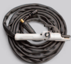
Pinza porta elettrodi Special con cavo da 4 metri (inclusa)
