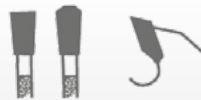
Denti da taglio TCG per laminati
