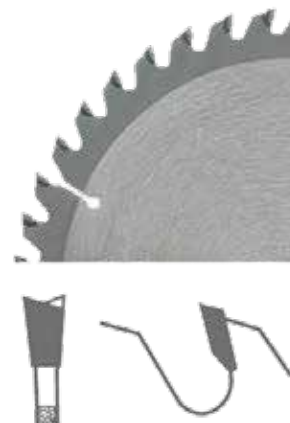
Denti ATB alternati con smusso superiore
